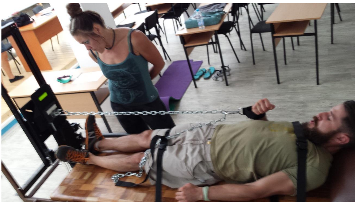
Фиг. 1 Позна на тялото и позиция на десния горен крайник при изпълнение на тест, използвайки стенд и изследователска система за измерване на силови параметри 3DSAC
